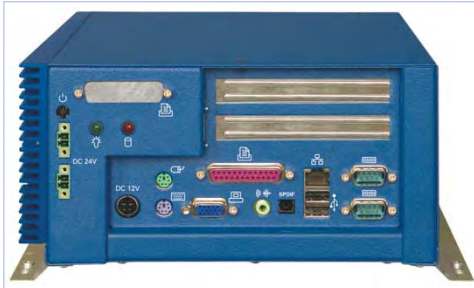
Abb.1: Der für raue Industrieanwendungen ausgelegte NanoServer E5 ist für vielfältige Steuerungsaufgaben geeignet
