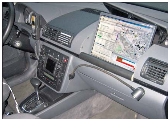
Bild 2: Das im Fahrzeug eingebaute Display erlaubt einen schnellen Überblick über die ortsabhängige Senderleistung
