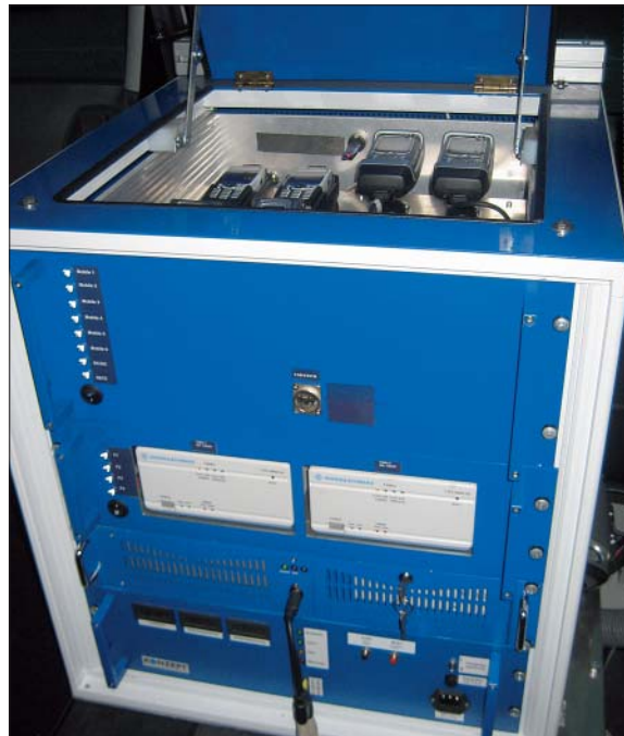
Bild 1: Das mobile Funkmesssystem mit Handys verschiedener Hersteller in einem O 2 -Fahrzeug
