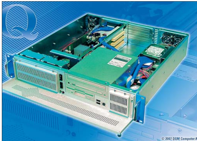
Bild 3: An den robusten Industrie-PC „Infinity M1584D“ lassen sich dank seines modularen Aufbaus viele unterschiedliche Messmodule anschließen
