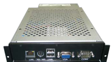
Bild 1: Die DSM Public Displays bestehen aus einem TFT-Monitor von NEC und einem integrierten Embedded-PC-Modul von DSM.
