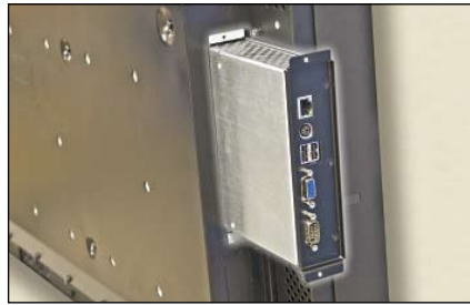
Bild 2: Das leistungsfähige Embedded PC-Modul 96M9356 basiert auf einem Intel Core 2 Duo Mobile-Prozessor T7400 und bietet eine Reihe von modernen Schnittstellen.
