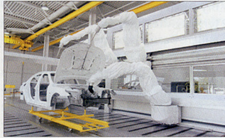
Bild 1: Typisches Einsatzgebiet für Industrie-PCs ist die Automobilindustrie. Hier lackiert ein PC-gesteuerter Roboter Karosserieteile
