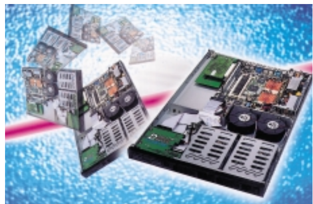
Zwei Lüfter führen die Wärme beider Pentium-III-CPU's trotz der gedrängten Bauweise ab.
