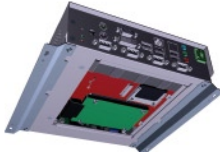
Abb. 3: Dank einer aufschraubbaren Bodenklappe sind Harddisk, Compact Flash (CF)-Sockel, die Speichererweiterungen und der interne Mini PCI Express x1 Slot direkt von außen erreichbar.
